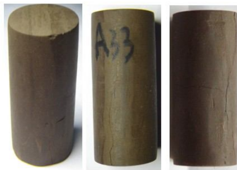
图 4 不同浸泡时间试样对比图 Fig.4 Sample comparing chart on different immersion times
